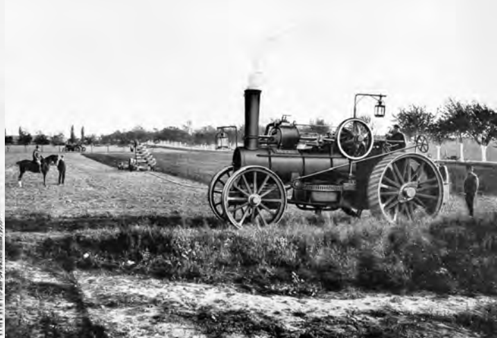
Abbildung 4: Lokomobile mit fahrbarer Dresch- maschine bei der Arbeit (um 1900).
