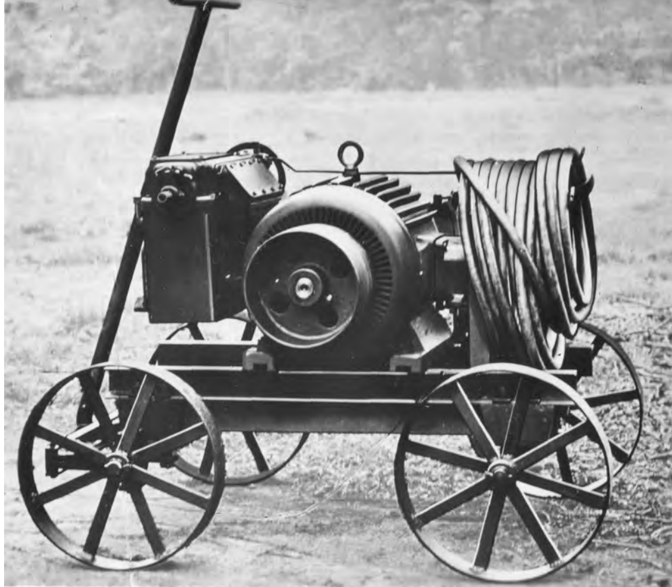
Abbildung 12: Motorisierung/Elektro: Geschl. Drehstrom-Schleifringläufer-Motor 15 kw SSW 1929.
